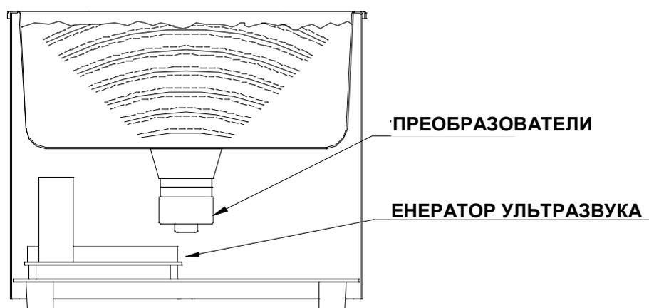
Ванна ультразвуковой мойки EUROSONIC® 3D имеет систему вибрации, называемую: **SWEEP MODE**, то есть, вибрацию со сдвигом частоты. При таком типе работы стационарные ультразвуковые волны "разбиваются". Таким образом, достигается равномерная вибрация и лучшая и более быстрая очистка предметов.
