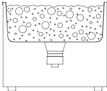
Взрываясь внутрь, микропузыри высвобождают определенное количество энергии и затем, благодаря силе удара способны отсоединить частицы грязи от предметов, погруженных в жидкость.
